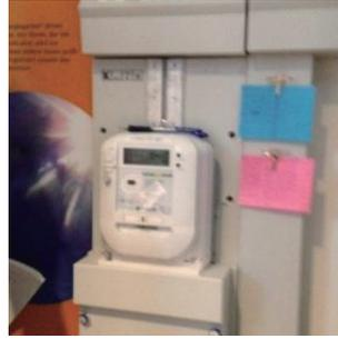
ロランではスマートメーターの設置が進んでいる。リアルタイムの電力の使用量がわかる。日本の東京電力管内では、平成26年度から32年度までに順次スマートメーターへの移行が図られる予定。
